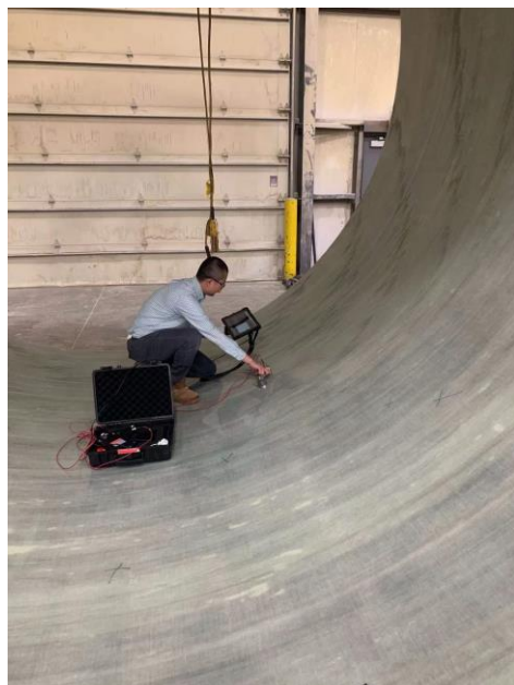
图 8. 使用定制波形算法对 4.9 米直径管道进行超声波检测。
